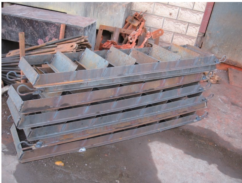
上海東南模板工程有限公司にて階段枠を撮影
