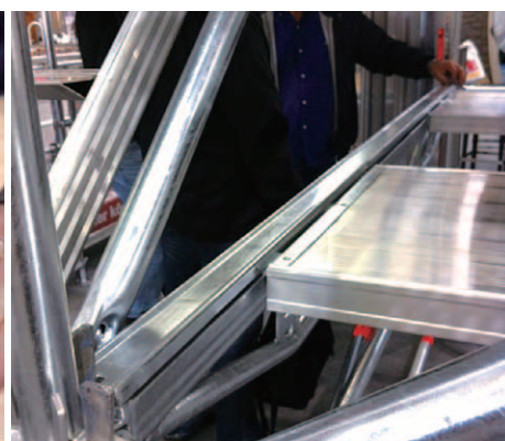
床材の浮上り防止機構
