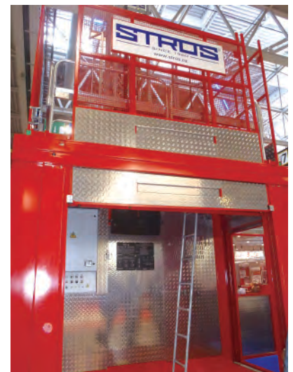
試乗した工事用エレベータ
