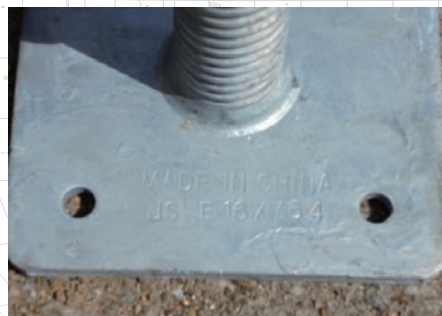
図24 中国製のジャッキ型ベース金具
