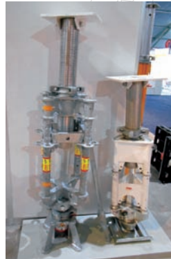
支柱とジャッキを組み合わせた重量支保工のジャッキ
