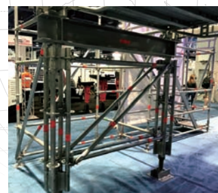
支柱（φ48.6）、水平材、斜材で構成された支保工
