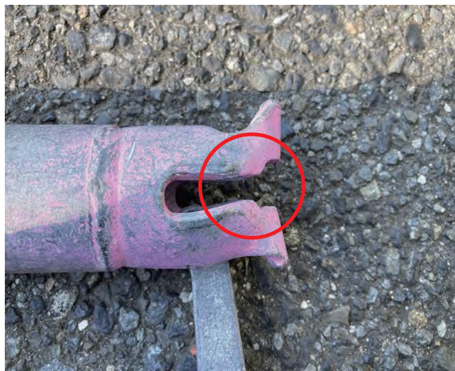
写真2-7 緊結部付布材の緊結部の変形（廃棄）
