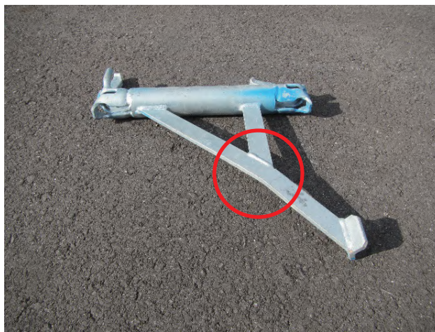
写真2-17 緊結部付ブラケットの斜材の曲がり（修理又は廃棄）
