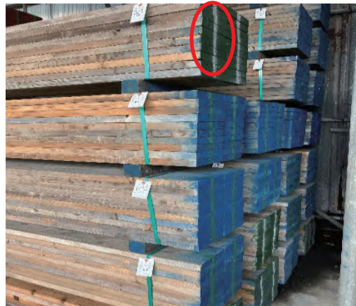
写真4-17 杉足場板（青色）
