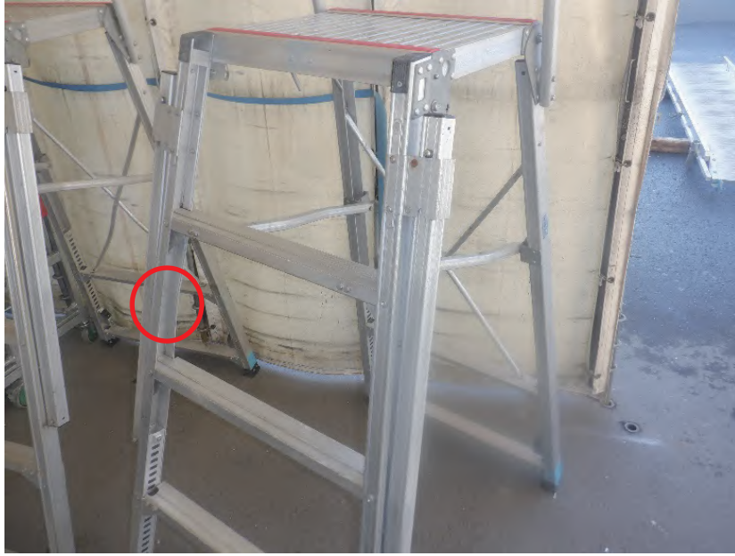
写真2-32 脚柱のへこみ（修理又は廃棄）
