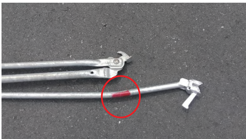
写真2-18 くさび緊結式足場用先行手すりの曲がり（修理又は廃棄）
