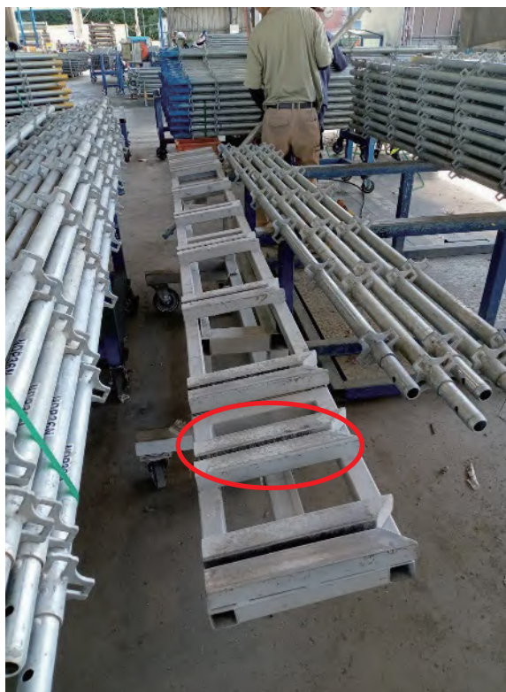
写真4-4 くさび緊結式支柱のフランジの曲がり確認治具 (溝(○印)にフランジを入れて曲がりを確認する。)
