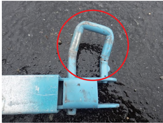
写真2-27 システム式防護柵（朝顔）の押え取り 付けスライドピンの変形（廃棄）
