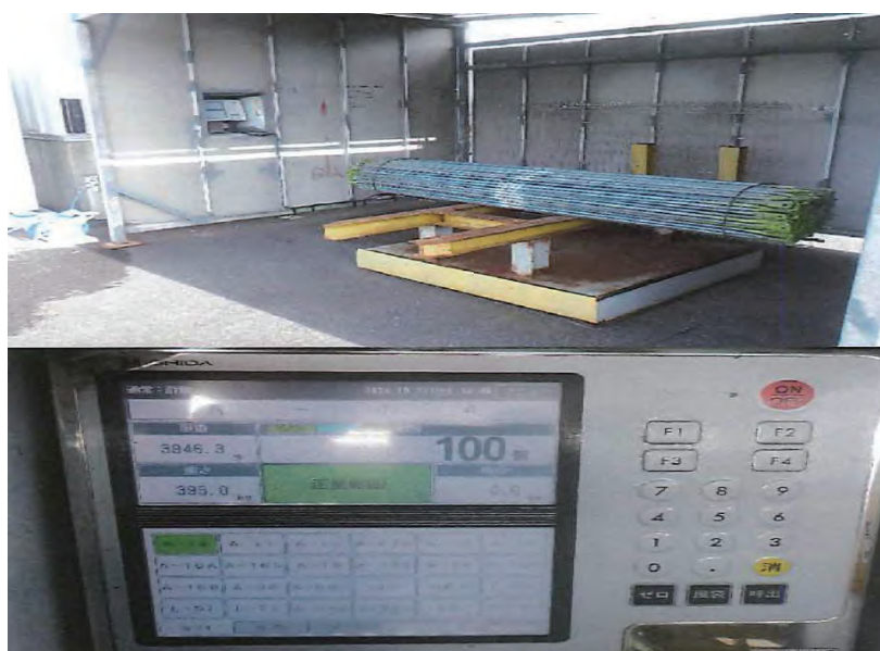
写真 4-30 屋外計量器の使用例
