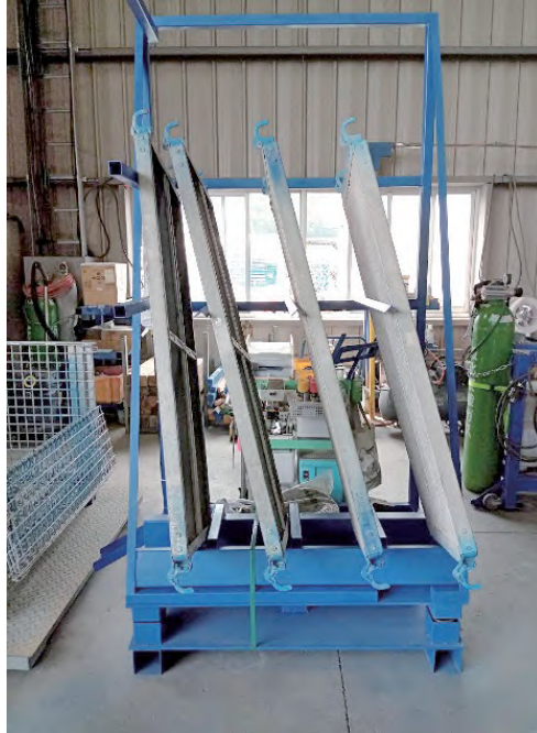
写真4-1 ショットブラストメディア（ショットブラストの粒）除去装置 （モーターの振動によりメディア除去を行う）表側
