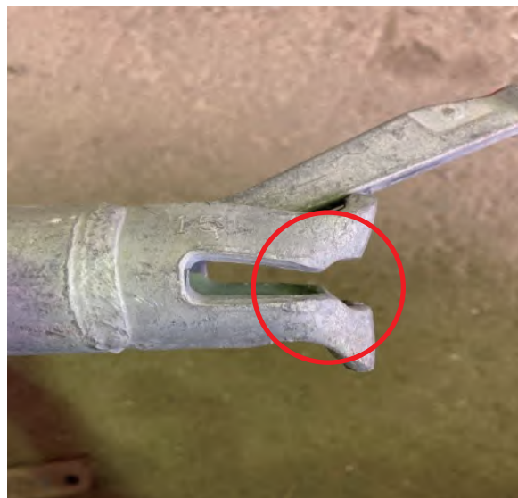
写真2-8 緊結部付布材の緊結部の変形（廃棄）
