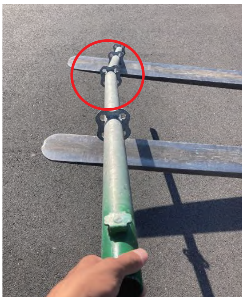
写真2-5 緊結部付支柱の曲がり（廃棄）
