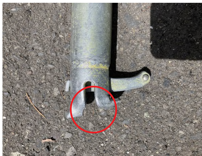
写真2-9 緊結部付布材の緊結部の変形（廃棄）
