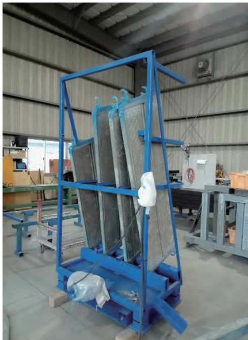
写真4-2 ショットブラストメディア（ショットブラストの粒）除去装置 （モーターの振動によりメディア除去を行う）裏側
