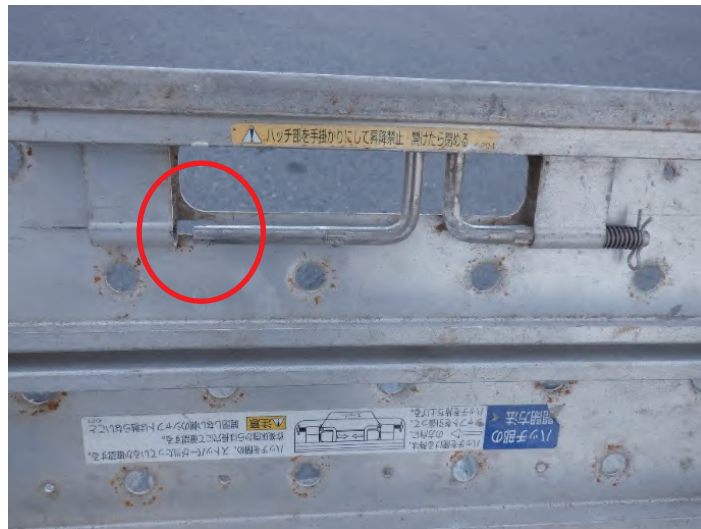
写真2-14 アルミ製ハッチ式床付き布わくの シャフトバネ欠落 (取替)
