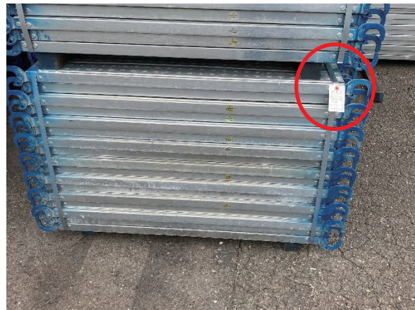
写真4-9 「整備済」取付例
