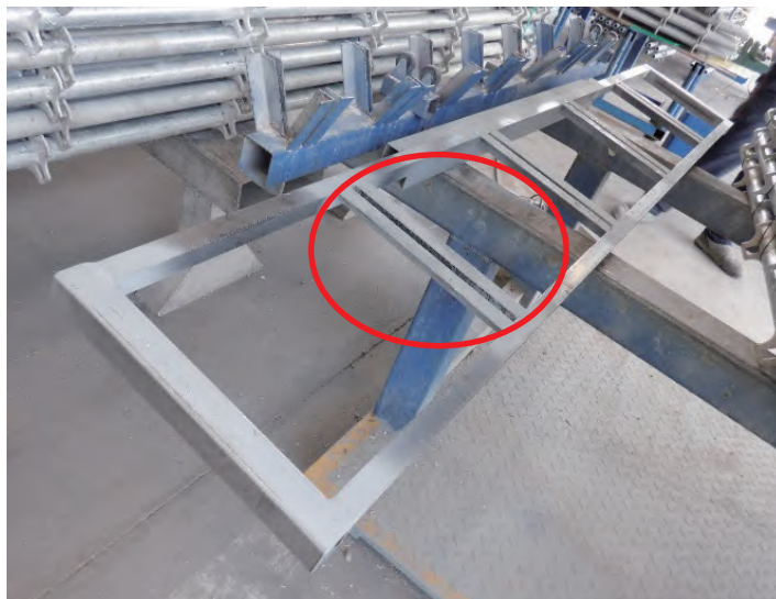
写真4-3 くさび緊結式足場の支柱のフランジの曲がり確認治具 (溝(○印)にフランジを入れて曲がりを確認する。)
