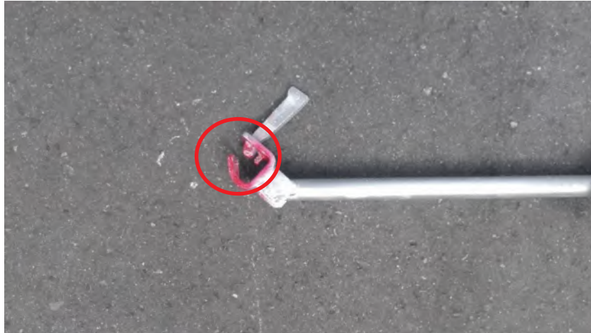
写真 2-19 くさび緊結式足場用先行手すりのくさび部の曲がり（廃棄）
