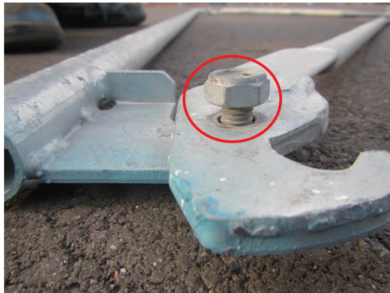
写真 2-20 くさび緊結式足場用先行手すりの取付部のボルトの緩み（ボルトの締め直し）
