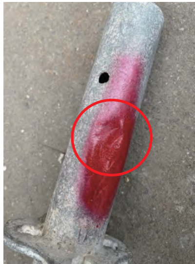
写真2-2 緊結部付支柱のへこみ（廃棄）
