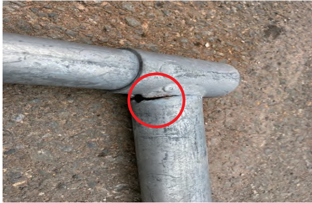
写真2-16 緊結部付ブラケットの亀裂（廃棄）
