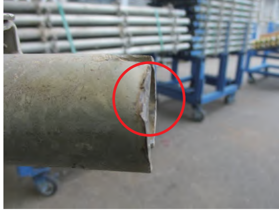
写真2-1 緊結部付支柱の小口部の切断（廃棄）
