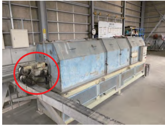
写真4-33 単管ケレン矯正機の単管出口部安全カバーの取付前 (駆動チェーン露出部あり) 改善前
