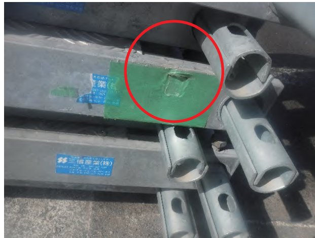
写真2-22 システム式つりだな足場の床材のテープ（除去）
