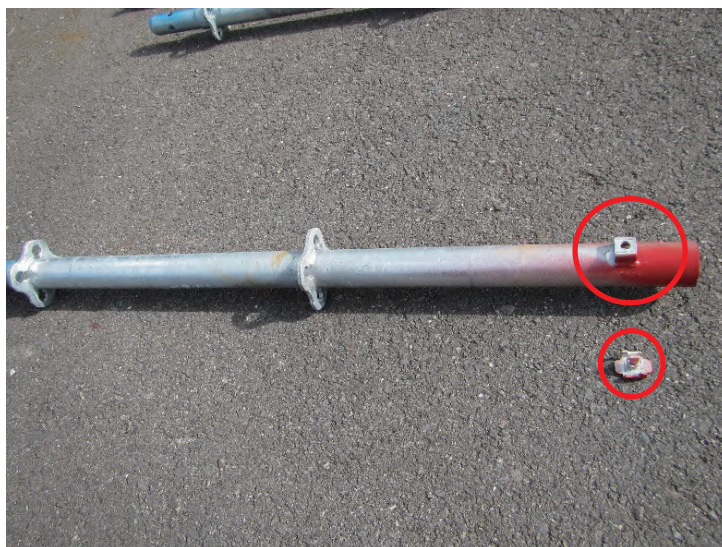
写真2-6 緊結部付支柱のロック金具の脱落（取替）
